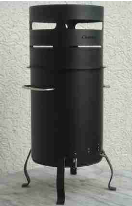
Abbildung 2: Der chantico-Terrassenofen bahnte mir den Weg in die Köhlerei 2.0. Die Konstruktion ermöglicht die Verbrennung der Schwelgase oberhalb des eingeschichteten Brennguts, so dass nach dem Kochen durch Ablöschen des Rest-Brennstoffs Kohle geerntet werden kann.
