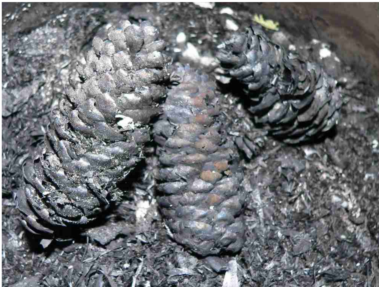
Abbildung 4: Im Topf bleibt Kohle zurück, die in ihrer Struktur noch dem Ausgangsmaterial entspricht
