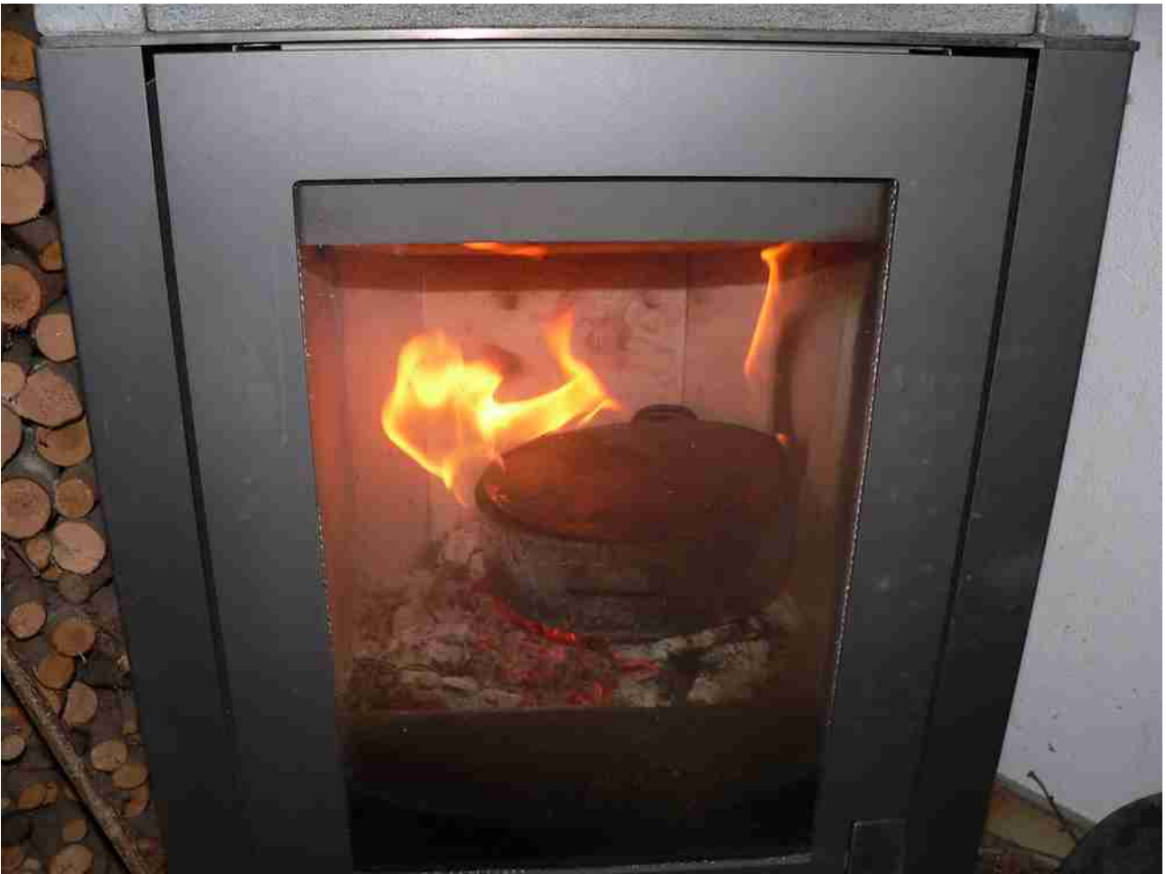
Abbildung 3: Kohleproduktion im Kaminofen: der Ofen muss bereits gut warm sein, wenn der Topf, gefüllt mit Sähespänen und sonstigem holzigen Material bedeckt in den Brennraum gestellt wird. Nach kurzer Zeit treten um den Deckel Schwelgase aus, die dort sauber verbrannt werden.
